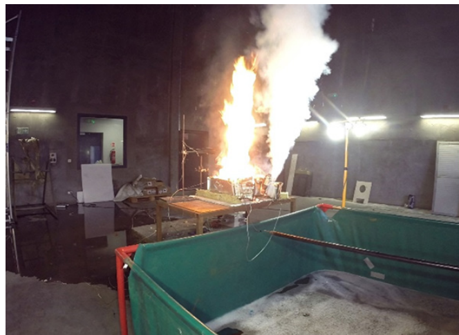
❸ Jednoczesny płomień (jedna cela) i wyrzut gazu (druga cela)
