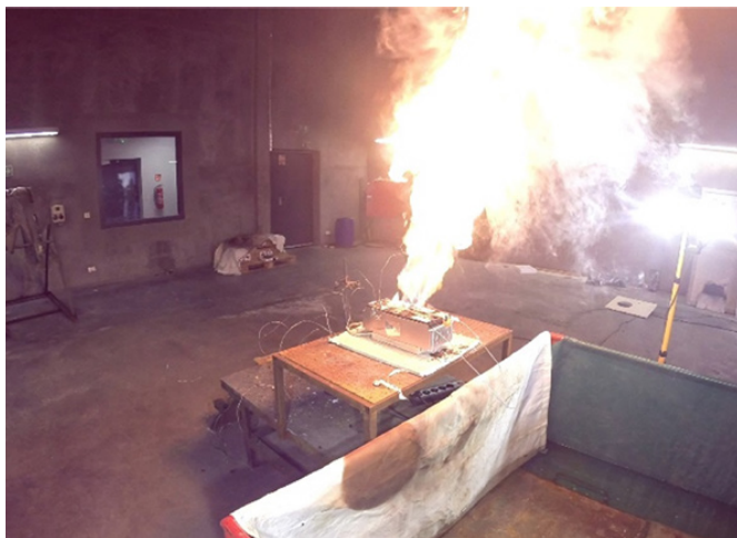
4 Rozerwanie otworu wentylacyjnego. Zwarty strumień ognia powstały w wyniku zapłonu gazów
