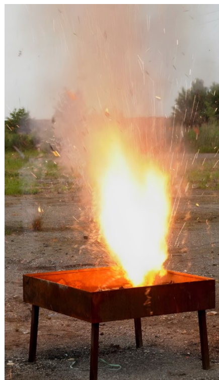
2 Wyrzut iskier podczas pożaru baterii litowo-jonowej
