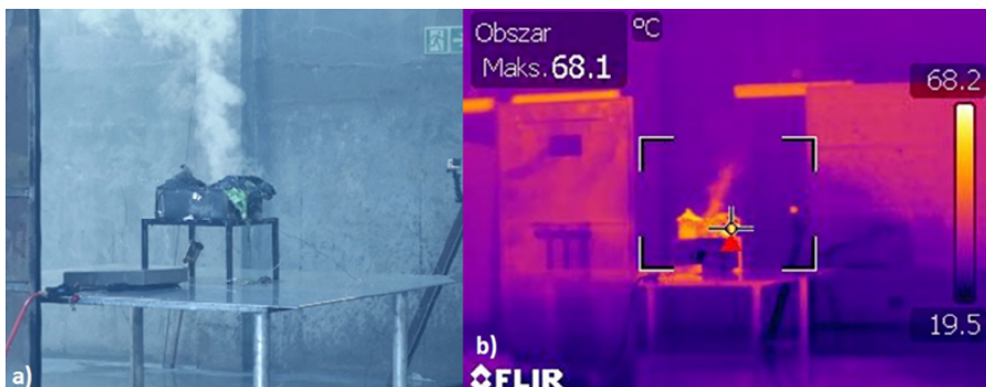
6 a) dym unoszący się bezpośrednio po zakończeniu gaszenia, b) wzrost temperatury na powierzchni modułu po zakończeniu działań gaśniczych (widok z kamery IR)
