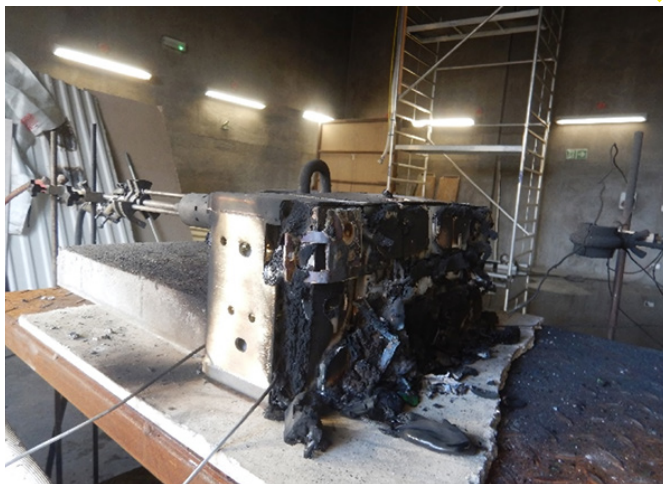
❷ Moduł NMC po pożarze
