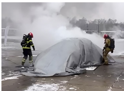
5 Użycie plandeki gaśniczej podczas pożaru samochodu elektrycznego
