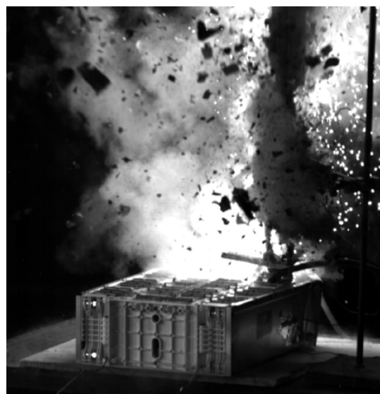
❶ Rozerwanie celi wskutek przeładowania ogniwa LTO
