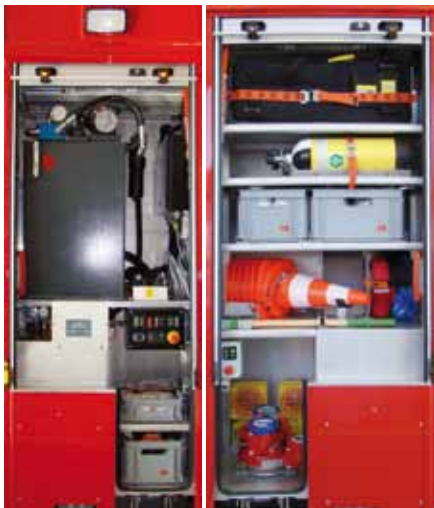
↑ Wnętrze modułu masztu gaśniczego HRET
